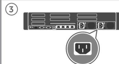
Podłącz system do zasilania. Povežite sistem na izvor napajanja. Sistemi bir güç kaynağına bağlayın.
