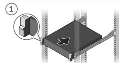
Zamontuj system na stelażu. Montirajte sistem na stalak. Sistemi bir rafa yerleştirin.
