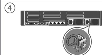
Zegnij kabel zasilania w pętlę i zamocuj go, używając zacisku podtrzymującego. Namotajte i pričvrstite kabl za napajanje u spojnici. Kabloyu kıvrıp tutma klipsine sabitleyin.
